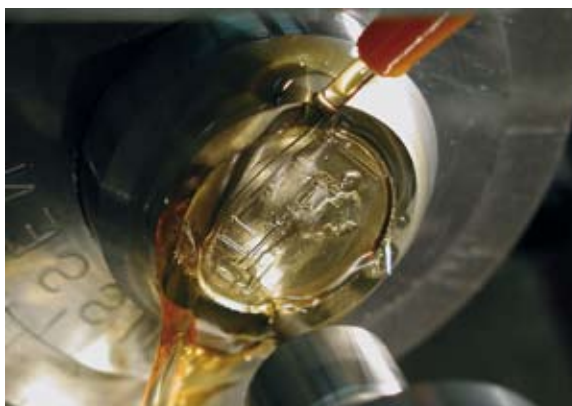
Fräsen eines Medaillenstempels auf der Reduktionsmaschine
