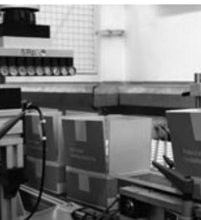
Simultanément, une autre machine prépare les cartons; ceux-ci étant stockés à plat, elle les déplie, colle les fonds et les assemble au moyen d'agrafes en métal. Les cartons ainsi préparés sont alors placés sur un autre tapis roulant où ils attendent leur précieux contenu.
