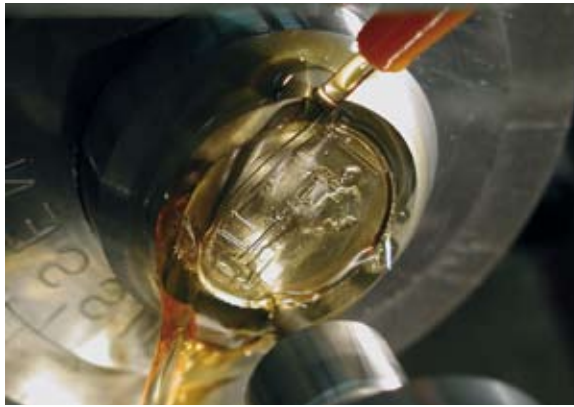
Fraisage d'un coin de médaille sur le tour à réduire
